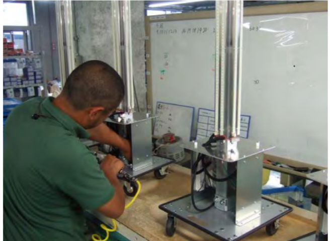
照明器具 配线连接工序
